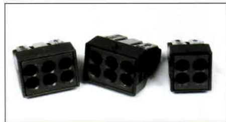
Клеммы серии 773 с пастой применяются в распределительных коробках для соединения как медных, так и алюминиевых проводов сечением 0,75—4 мм 2
