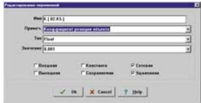
Переменная K имеет атрибут Удаленная и связывается с переменной K5 на сетевом узле с адресом 02
